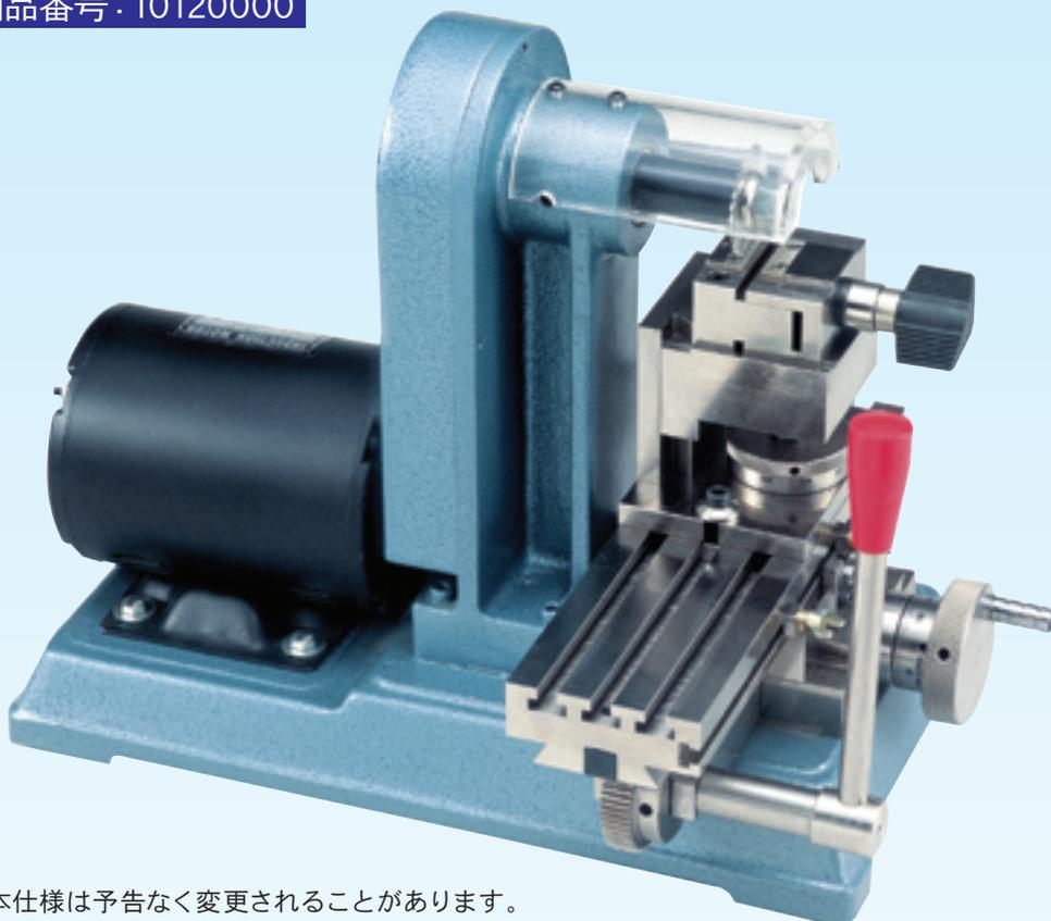
棒キーのサグリ溝加工をする為の専用治具を標準装備。(下図参照)
